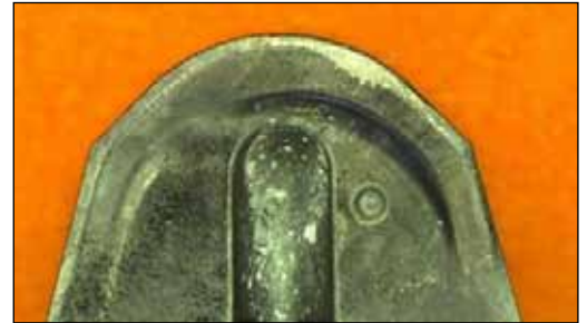
Verschleißbilder Schneidplatte 05 90 850 R30
