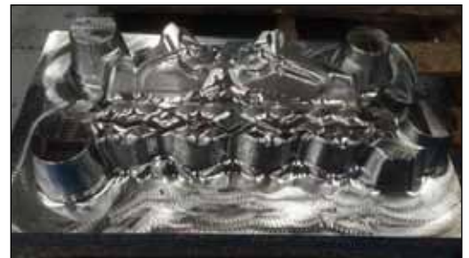
1.2344 / H13 - 35 HRC: Bauteil und Späne
