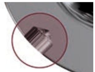
Équilibrage par enlèvement de matière par perçage. Exemples de calculs et croquis détaillés à la page suivante.
