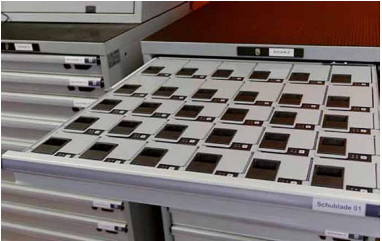
Kleinteile und Werkzeuge sind in Schubladenschränken am Besten aufgehoben. Dank der elektronischen Verriegelung wird ein Schubladenschrank zur dynamischen Lagertechnik und sorgt für mehr Wirtschaftlichkeit und Sicherheit im Betrieb.
