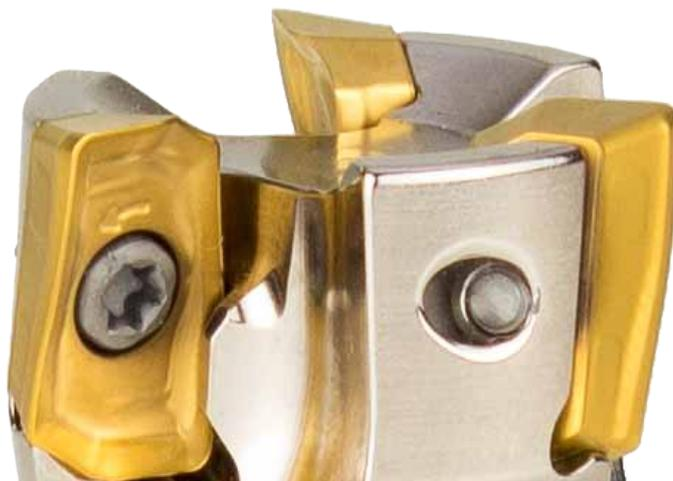
Dank des eingebetteten Plattensitzes ist eine kleine Torxschraube verwendbar. So entsteht weniger Unwucht auf dem Werkzeug, was zu einer erhöhten Laufruhe der **SLOTWORX®**-Werkzeuge führt. Selbst in tiefen Kavitäten besteht daher die Möglichkeit, mit hohen Schnittwerten präzise und vibrationsarm 90° Schultern zu bearbeiten. Glatte
