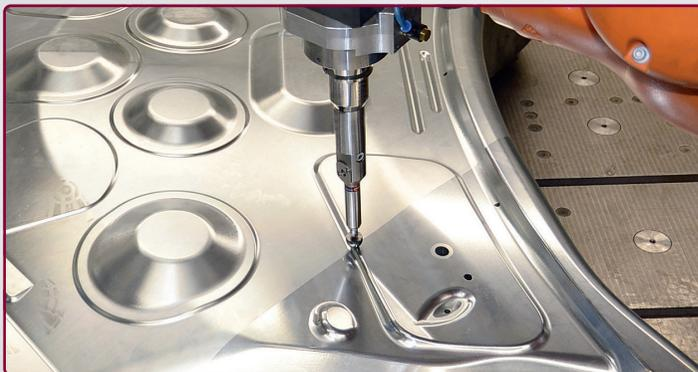
Kaltschmieden eines Serien-Ziehwerkzeugs mit FORGEfix® auf einer Roboter-Werkzeugmaschine
