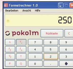
Der Schnittdatenrechner ermöglicht Ihnen eine schnelle Berechnung von Vorschub, Drehzahl, Schnittgeschwindigkeit oder Vorschub pro Zahn - eine automatische Vorgabe erleichtert Ihnen die Handhabung.
