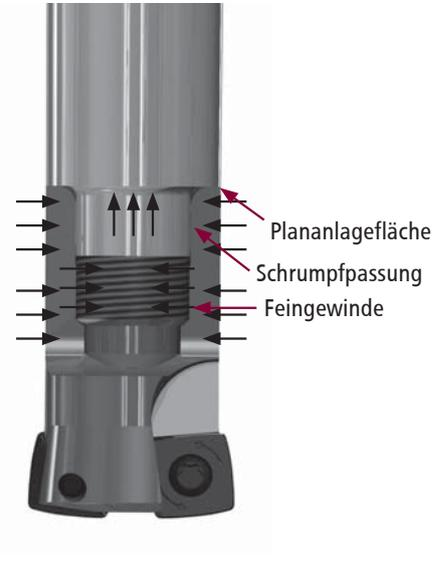
Das Pokolm-DuoPlug®-System bietet optimale Stabilität bei höchster Präzision und Rundlaufgenauigkeit. In Ergänzung zu herkömmlichen Einschraubwerkzeugen wirken die Haltekräfte zwischen Werkzeug und Aufnahmesystem vollflächig über die gesamte Schrumpfpassung sowie weite Teile des Schrumpfgewindes. Beachten Sie die Montageanleitung DuoPlug® im Kapitel „Technische Daten“ für weitere Informationen.
