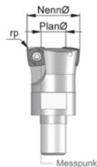
Messpunktbestimmung für die Längenmessung mit Laser. Für die Messpunktbestimmung durch die Längenmessung mittels Laser muss das Maß Plan Ø verwendet werden.
