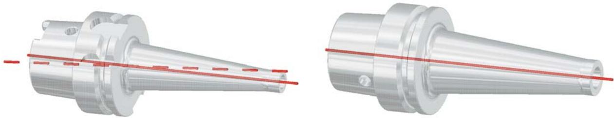
Rotationsachse  $\neq$  Masseachse
