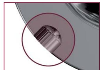
↗ Equilibrage par enlèvement de matière par perçage Exemple de calcul et croquis détaillé sur la page suivante.
