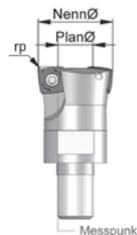
Définition des points de mesure pour la cote de réglage en hauteur avec le laser. Pour la définition du point de mesure au laser, on doit utiliser la cote Plan Ø.
