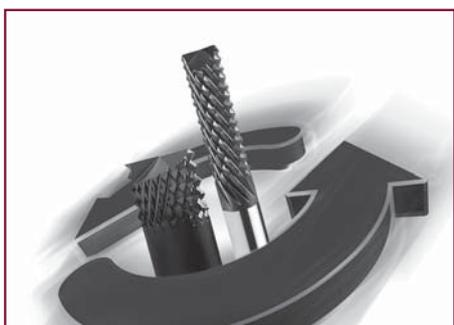
Les outils les plus récents pour l'usinage du graphite sont les fraises à arêtes pyramidales pour l'ébauche. Fraises 2 Tailles de diam. 3 à 16mm répondent en tout point pour les opérations d'ébauche souhaitées. Les fraises pour l'usinage du graphite sont pourvues d'un revêtement au diamant récemment développé. Cela garantit une durée de vie élevée et une évacuation optimale des copeaux lors de l'usinage d'électrode graphite en volume important.
