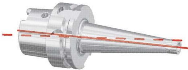
Rotationsachse  $\neq$  Masseachse
