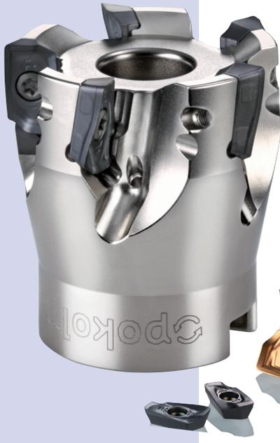
Die Werkzeugexperten aus Harsewinkel unterscheiden für RSH-Anwendungen Rundplatten-, Eck- und Nutfräser sowie Hoch-Vorschub-Werkzeuge. Sie sind mit der patentierten Wendeplatteneinbettung und inneren Kühlmittelzufuhr ausgestattet. Bei den Rundplattenfräsern kann der Anwender zwischen den Ausführungen 0° und 7° positiver Rückspanwinkel wählen. Die neuen Wende-schneidplatten erhöhen die Prozesssicherheit selbst beim Spanen hochwarm-fester Legierungen.
