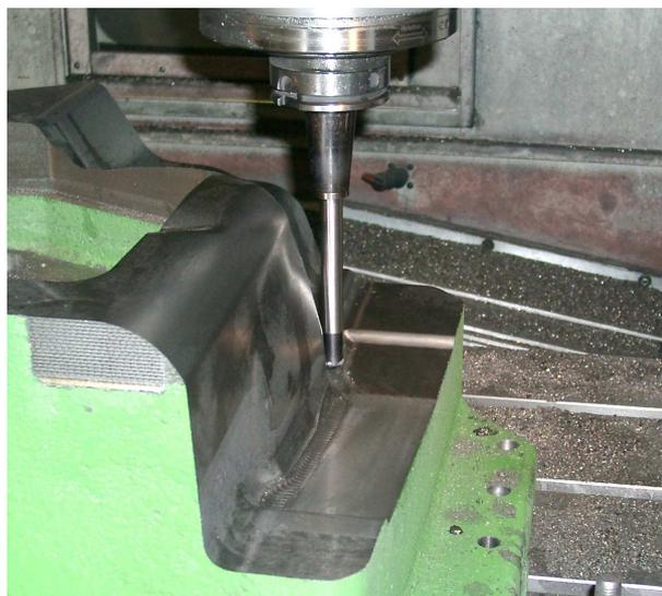
Nach über acht Stunden im Einsatz zeigt die Wendeschneidplatte noch keinen erkennbaren Verschleiß. Die gesamte Form kann ohne Unterbrechungen fertig bearbeitet werden. Wäre noch mehr Finishing nötig, so könnte dies auch ohne Wechsel der WSP erfolgen.
