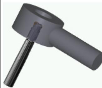
Induktive Erwärmung mit Pokolm Induktions-Schrumpfgerät TSI 3510 für **6 bis 15 Sekunden** je nach Durchmesser. Be-ginnen Sie anschließend **sofort** mit Schritt 4.
