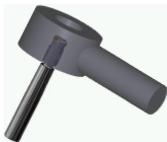
Induktive Erwärmung mit Pokolm Induktionsschrumpfgerät TSI 3510 für **6 bis 15 Sekunden** je nach Durchmesser.
