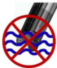
Die entschrumpften Einzelteile dürfen **nicht abgeschreckt** werden. Kühlen Sie sie stattdessen mittels der Luftkühleinrichtung des Schrumpfgerätes TSI 3510 langsam ab oder benutzen Sie die Ablagestation.
