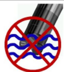
Die geschrumpfte Werkzeug-Auf-nahmeneinheit darf **nicht abge-schreckt** werden, sondern sollte mittels der Luftkühleinrichtung des Schrumpfgerätes TSI 3510 gleich-mäßig abgekühlt werden. Durch das Abkühlen des Werkzeuges zieht sich die DuoPlug®-Kappe wieder zusammen. Es entsteht
