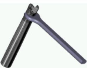
Durch die induktive Erwär-mung weitet sich die Pas-sungsbohrung des Werk-zeuges. **Erst jetzt** kann das Werkzeug mit einem pas-senden Maulschlüssel bis zur Anschlagfläche der Auf-nahme festgedreht werden.
