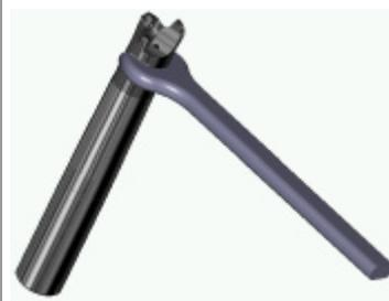
Durch die induktive Erwärmung weitet sich die Passungsbohrung des Werkzeuges. **Erst jetzt** kann das Werkzeug mit dem passenden Maulschlüssel von der Aufnahme her untergedreht werden.
